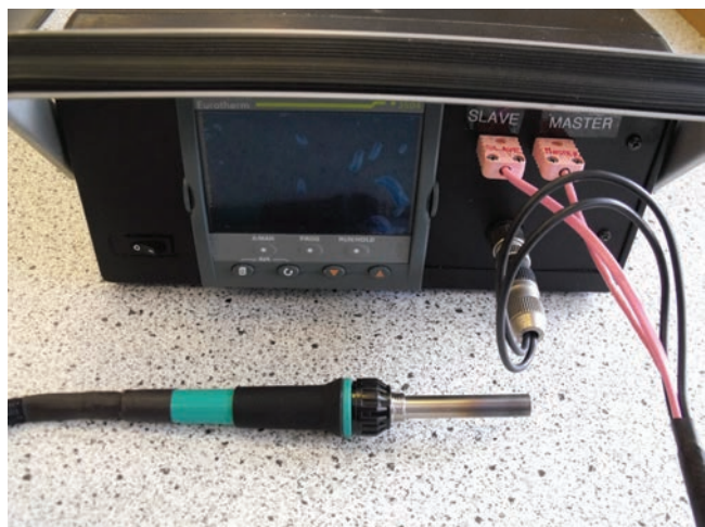
Obr. 13: Sestava dotykového kompenzovaného teploměru
