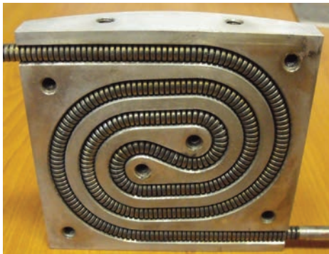
Obr. 7b: Spodní část zkušebního tělesa s topným elementem
