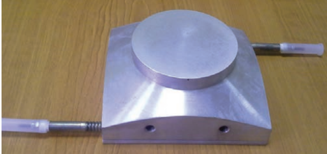
Obr. 7a: Zkušební těleso s topným elementem
