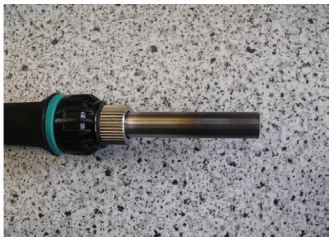
Obr. 14: Detail měřicí sondy dotykového teploměru
