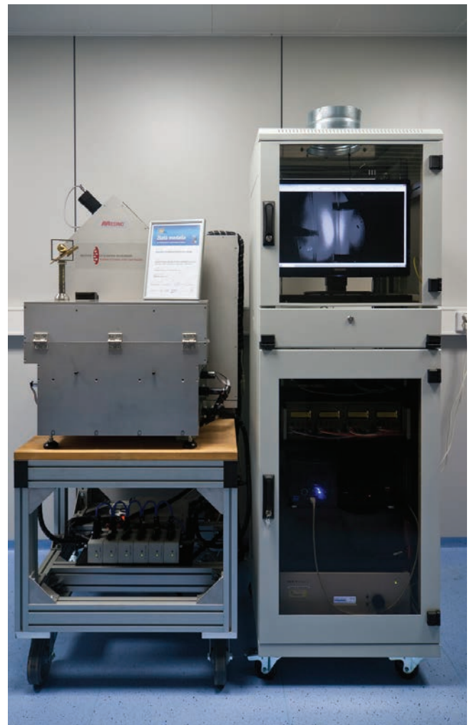
Obr. 1: Bezkontaktní systém pro měření délky KM [2]
