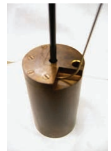
Obr. 3: Vyvinutá zařízení pro realizaci referenční teploty povrchu v různých státech
